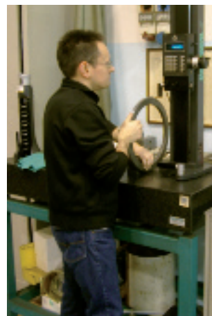
Altimetro: strumento per misure di diametri, altezze e interassi.
